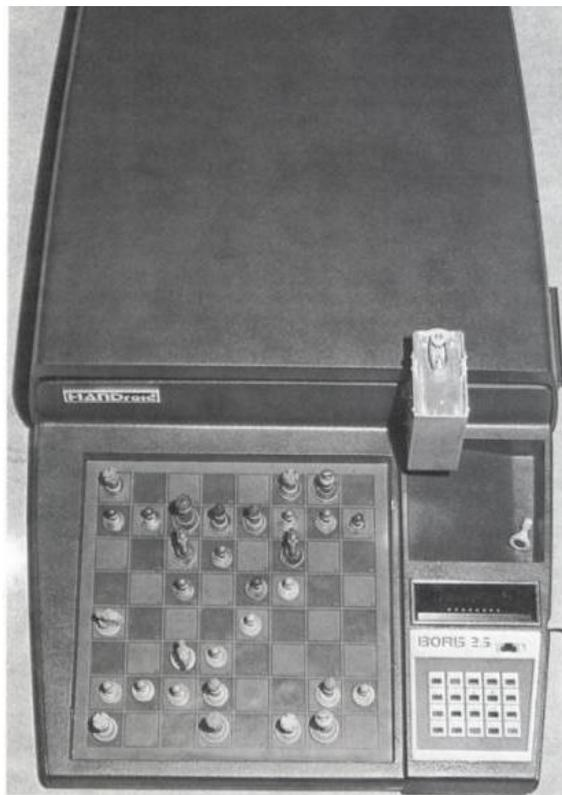
**Boris Handroid ist eine Art automatischer Schachspieler. Er verfügt über eine künstliche Hand, die fähig ist, die Schach- und Damesteine auf dem Brett selbsttätig hin und her zu bewegen.**
