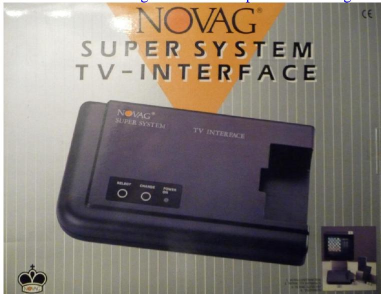
Alwin Gruber: Überträgt die Züge sowie die Zugzeiten an ein TV-Gerät. War insbesondere für den Einsatz bei Schachturnieren vorgesehen. Es kann zwischen 16 verschiedenen Brettfarben gewählt werden. Habe das TV-Interface bereits getestet und es funktioniert bei mir einwandfrei. Macht richtig Spass, die Schachzüge am Bildschirm anzusehen.
