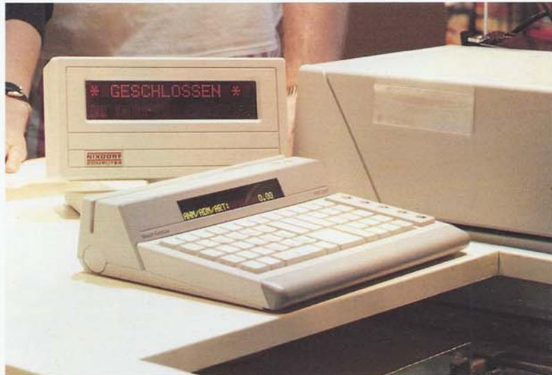
Vakuumfluoreszenz-Display in modernem Kassensystem
