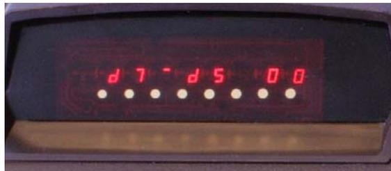
**Ketterling: Ein achtstelliges Display, allerdings werden diesmal rote Sieben-Segment-Anzeigen benutzt, so daß vor allem die Figurensymbole vereinfacht werden mußten.**
