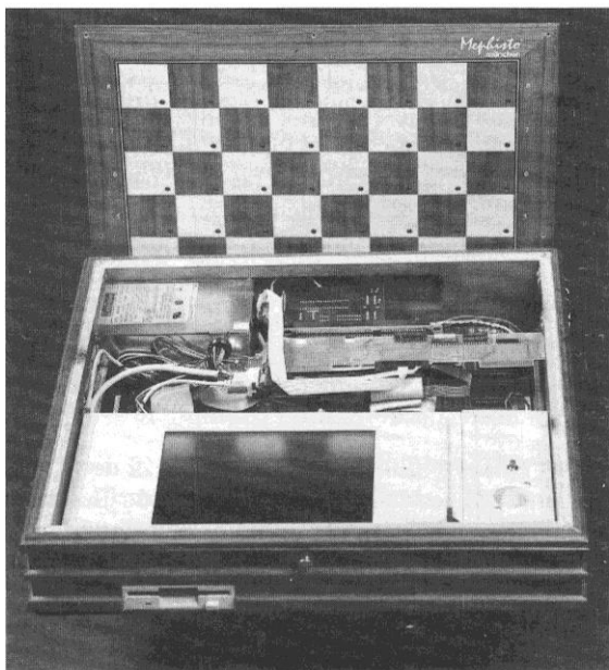
Geballte Technik im Innern der Maschine: Prozessorplatine mit i486/66, RAM-Sockel für bis zu 32 MB, Kombicontroller für Tastatur und Drucker, VGA-Grafikkarte, Spezialnetzteil mit Lüfter, etc.
