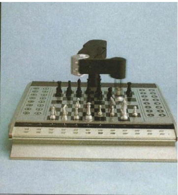
Schach-Computer „Robot“: Der zweite, der mit Hilfe eines Greifarms selbständig die Figuren setzt und schlägt – wenn er funktioniert
