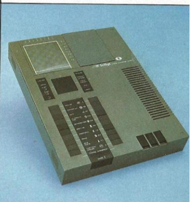
„Senator Chess“: Seine Stärke liegt nicht im Programm, sondern in der Technik. Die Figuren lassen sich mit einer Taste verschieben
