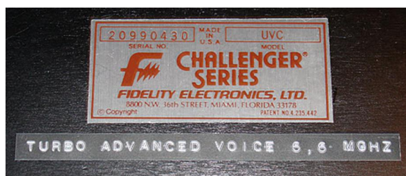
Den Fidelity "Turbo" Advanced Voice von Sammler Luuk Hofman, Getuned durch Arno Kreuzberg von 4 nach 6,6 MHz.
